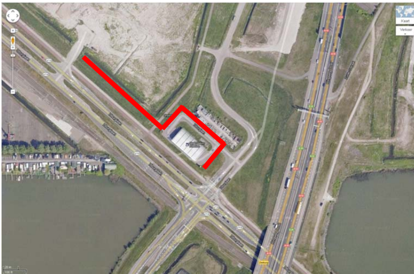
Figuur 2 Ligging grondwatermaatregel (huidig voorstel grindkoffer) Bedrijvenstrook (in rood) ten bate van de grondwaterbeheersing
