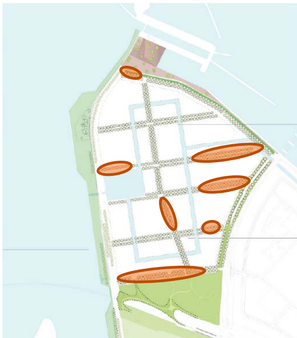
Figuur 7 Knelpuntenzones bij bomenrijen (in oranje), waar de ontwatering <80 cm is bij keuze voor de minimale grondwaternorm van 50 cm voor de Sluisbuurt.
