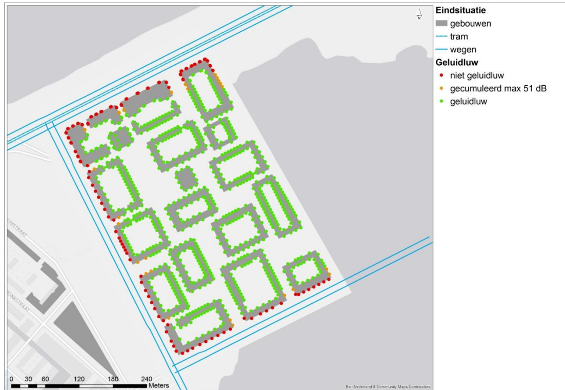
Afbeelding 4.7 Overzicht geluidluwe gevels en geveldelen
