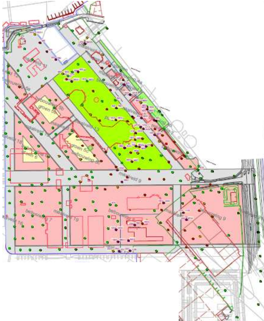
Figuur 3.2. Verontreinigingssituatie in het grondwater tegen de achtergrond van zowel de huidige bebouwing als plannen voor de toekomstige inrichting. Indien in geen van de grondwaterlagen (freatisch in de ophooglaag, in het 1 e WVP en het 2 e WVP) verontreiniging is aangetroffen (<S in de legenda) wordt dit weergegeven met een groen bolletje. Indien in 1 of meer lagen wel verontreiniging is aangetroffen, heeft het bolletje de kleur van de hoogst aangetroffen waarde ten opzichte van de Interventiewaarden.
