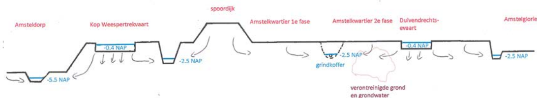
Figuur 10: Hoogteverschillen, waterpeilverschillen en de invloed daarvan op de stromingsrichting van het grondwater op een denkbeeldige lijn tussen Amsteldorp en Amstelglorie.
