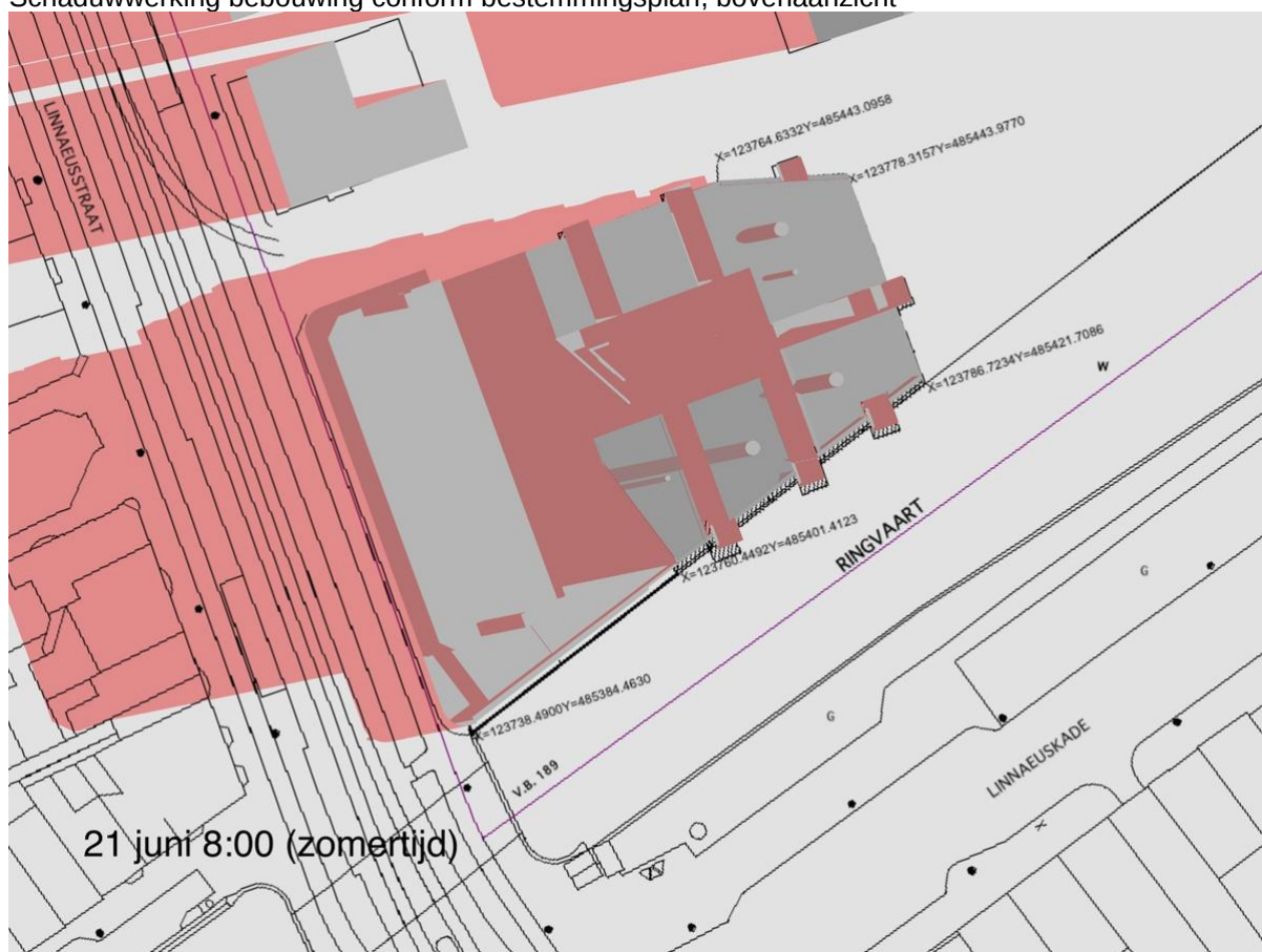
Schaduwwerking bebouwing voorliggend bouwplan, bovenaanzicht
