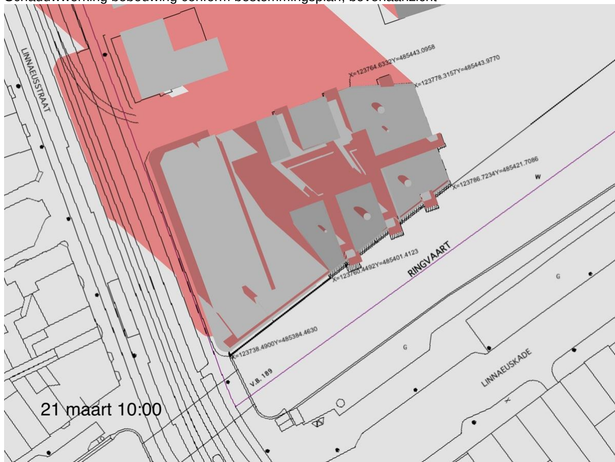
Schaduwwerking bebouwing voorliggend bouwplan, bovenaanzicht
