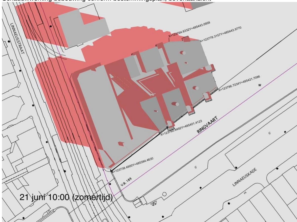
Schaduwwerking bebouwing voorliggend bouwplan, bovenaanzicht
