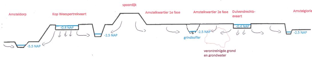
Figuur 13-10: Hoogteverschillen, waterpeilverschillen en de invloed daarvan op de stromingsrichting van het grondwater op een denkbeeldige lijn tussen Amsteldorp en Amstelglorie.
