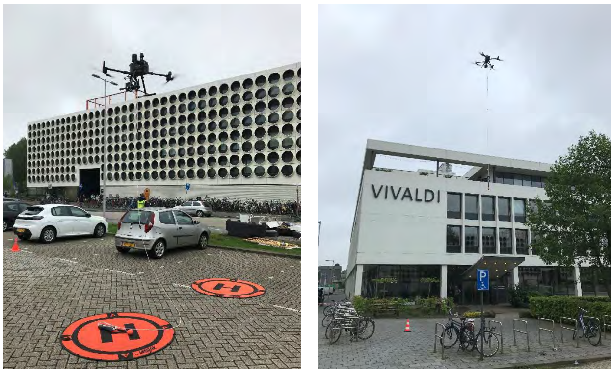
Figuur 4 Drone met meetinstrument tijdens de vlucht. Op de linkerfoto ligt het meetinstrument nog op de grond.
