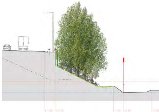
Figuur 6 Combinatie talud en grondkerende constructie
