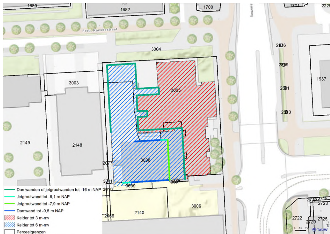
Figuur 1.4 Detailbeeld van de toekomstige kelder en dam/jetgroutwanden. Inmiddels (5-5-2022) heeft de aannemer laten weten dat een deel van de damwanden die na de bouw zouden blijven staan, verwijderd worden. Doordat de nieuwe kelder de ophooglaag al volledig afsluit (zie Tabel 3.1), heeft dit geen effect op de conclusies.
