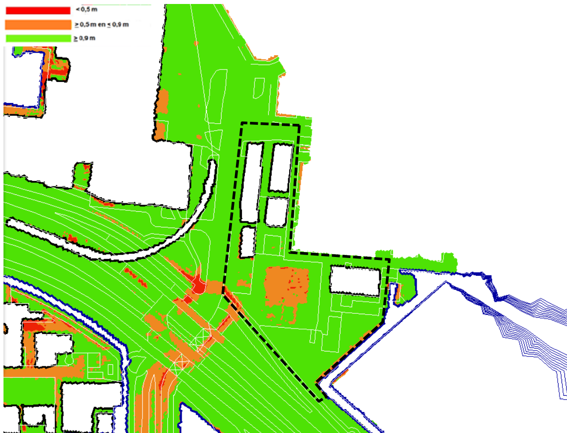
Figuur 3-3: Berekende ontwatering [m] in de huidige situatie 2016, zonder Groene Beek. De ontwatering wordt berekend op basis van de Algemene Hoogtekaart Nederland (AHN3) [bron vii ]. Zwarte kaders zijn ondergrondse constructies en blauwe kaders is oppervlaktewater in dunne grijsblauwe lijnen is de ondergrond geprojecteerd. De geblokte zwarte streep geeft de indicatieve plangrens aan.
