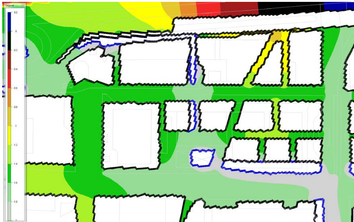
Figuur 4. 2: Berekende maatgevend hoge grondwaterstand in 2030 [m + NAP] inclusief klimaattoeslag uit klimaatscenario WH2050. Wit weergegeven vlakken betreffen: kelders (zwart omlijnd), oppervlaktewater (blauw omlijnd). De ondergrond is de KBKA van 2015 [14].
