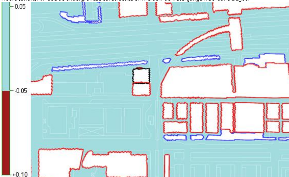
Figuur 4-3: Verschil tussen de berekende maatgevende grondwaterstand (m) in het ontwikkelingsscenario zonder- en met de ontwikkeling van kavel 3 Noord (zwart). In rood de ondergrondse constructies en in blauw de watergangen. Schaal is 1:2500.
