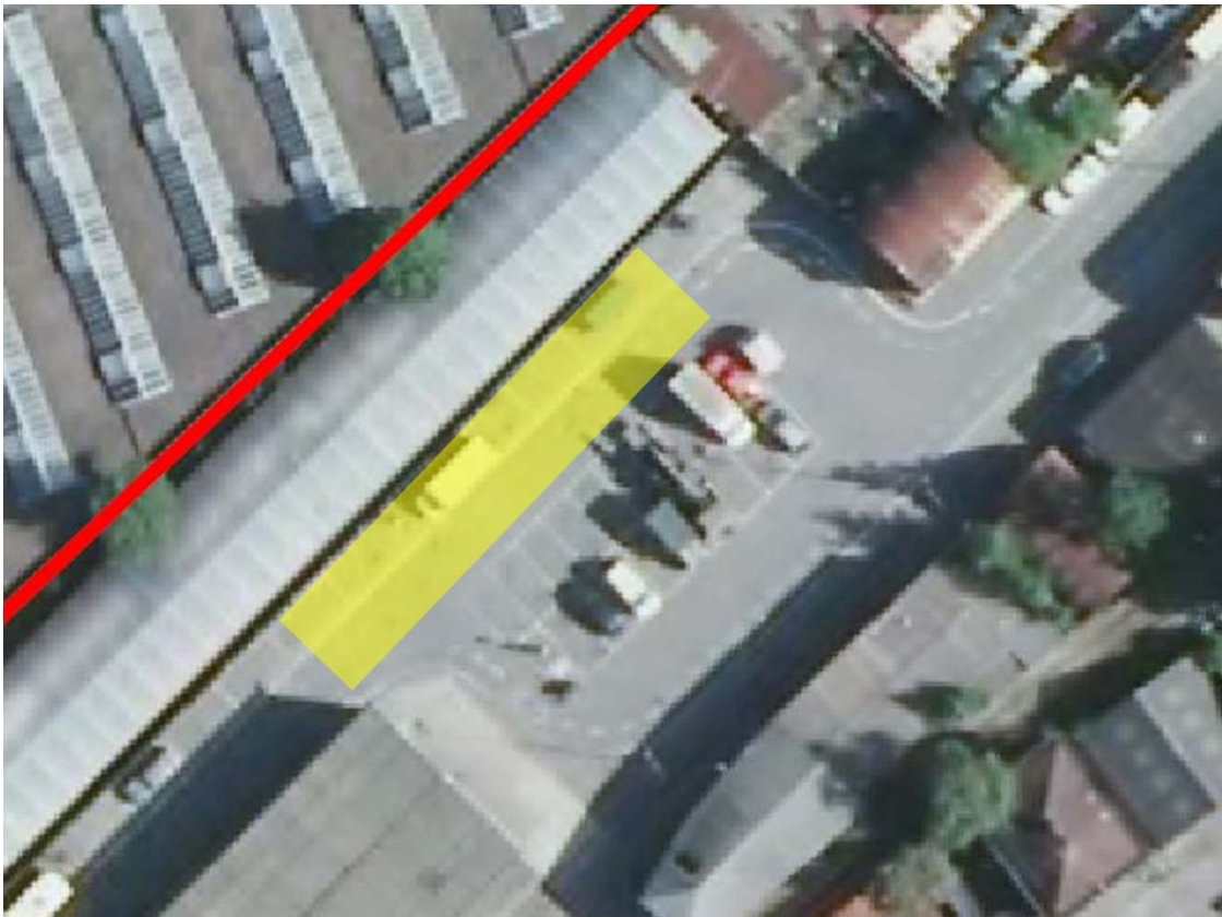
Figuur 8-3 Berekende 0,4 microtesla-contour boven de HS-kabels op de parkeerplaats middenin de Havenstraat. De contour is 10 meter breed gerekend vanaf de muur van de GVB-remise. Op dit punt buigen de HS-kabels in zuidwestelijke richting af van de HS- en MS-kabelbundels die vanaf het station recht in de richting van de remise lopen. Zuidwestelijk van deze contour (tussen de remisemuur en de grote loods linksonder op de plattegrond, hier lopen de kabels verder) zijn de gecorrigeerde veldsterkten lager dan 0,4 microtesla.
