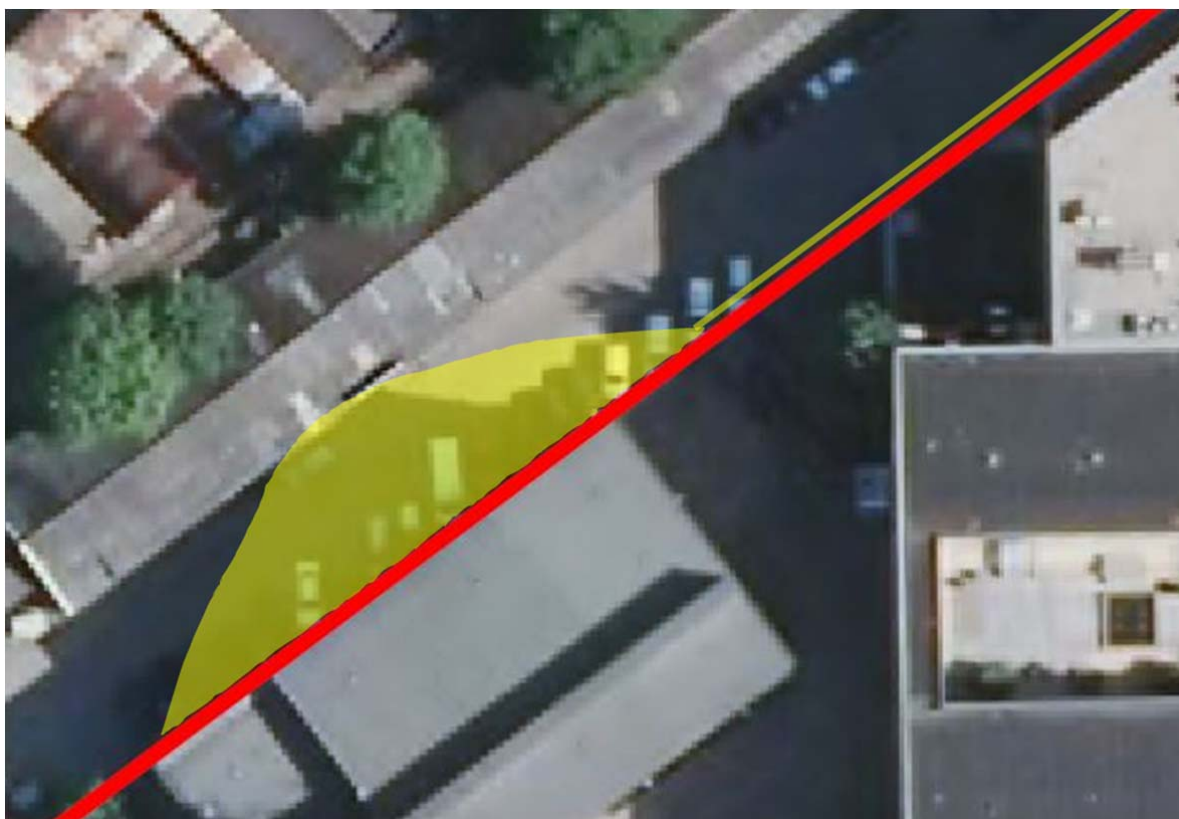
Figuur 8-1 Berekende 0,4 microtesla-contour van het onderstation van Liander met HS- en MS-kabels aan de kant van de Karperweg. De contour start linksonder op circa 2 meter binnen de noordwestelijke hoek van de muur van het onderstation. De contour verbreedt zich en bereikt de maximale breedte van 12 meter (loodrecht vanaf de stationsmuur) vanaf de beginpunten op respectievelijk 19 en 24 meter vanaf de noordwestelijke hoek van de stationsmuur. Het profiel versmalt tot een punt op 1 meter voorbij de noordoostelijke hoek van het hek voor het onderstation en gaat dan over in een recht profiel boven HS- en MS-kabels tussen 0,5 en 1,5 meter afstand van de gebouwen.
