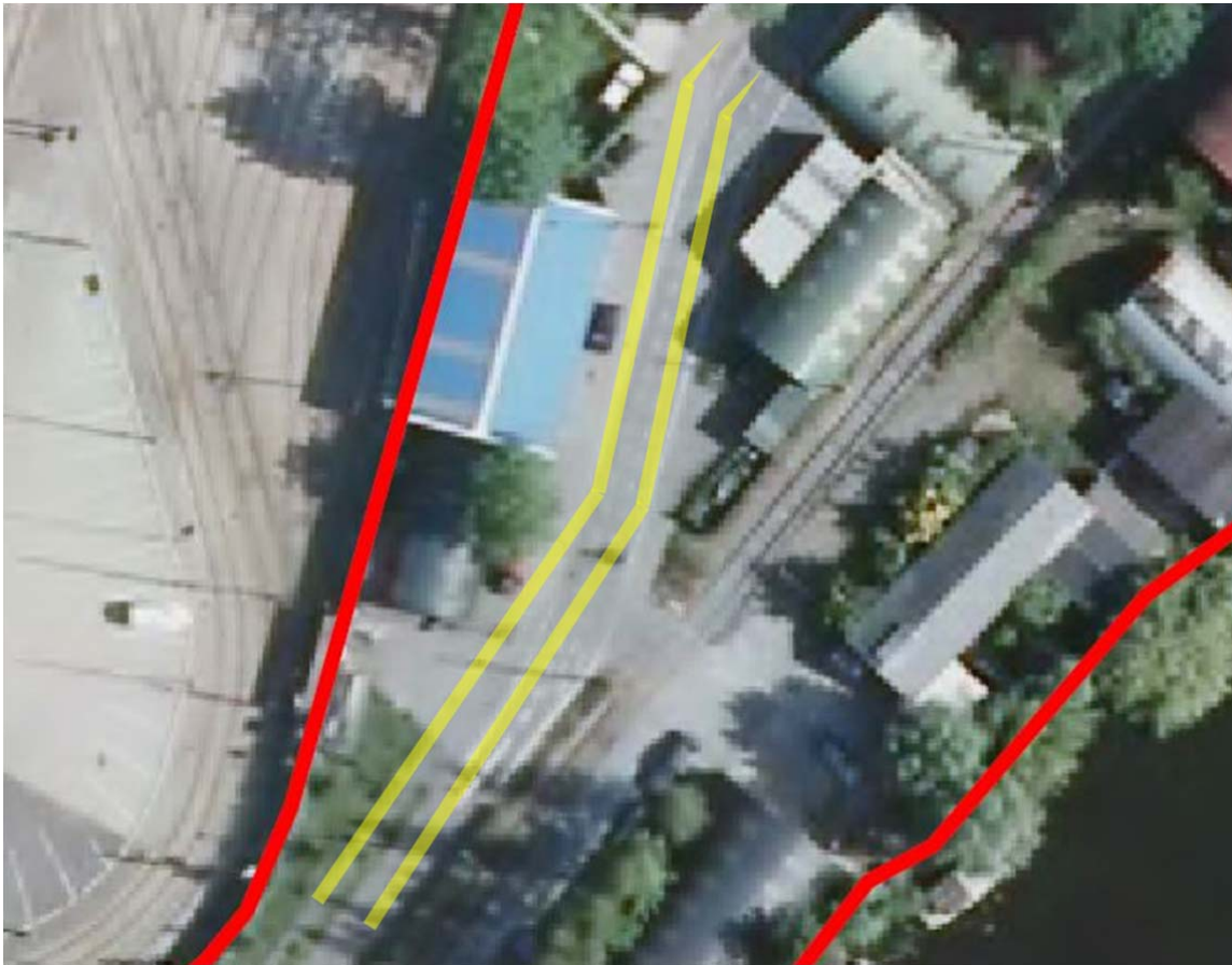
Figuur 8-4 Berekende 0,4 microtesla-contouren boven de HS-kabels onder het fietspad in de zuidwestelijke hoek van het terrein. Beide contouren zijn 3 meter breed en beginnen op respectievelijk 1,5 meter en 7,5 meter afstand vanaf de groene loods (iets links van het midden op de plattegrond). De contouren volgen de ligging van de beide HS-kabels onder de Havenstraat tot het aangegeven bovenste punt; tussen deze contouren en de contour in figuur C3 waren de veldsterkten lager.
