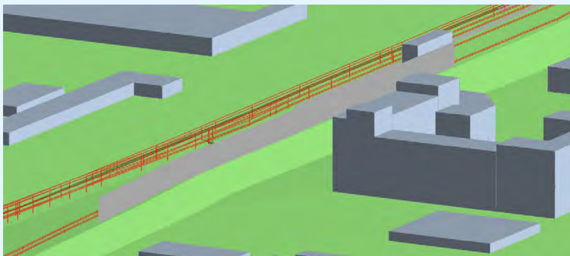
figuur 10: locatie geluidsschermen (7 meter hoogte)
