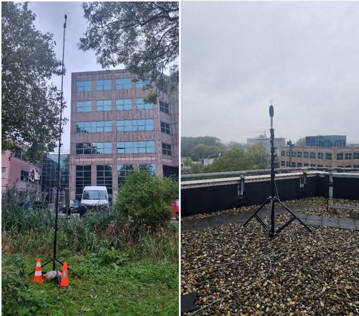
Figuur 2: Foto's van de microfoons op 1,5 en 7,5 m hoogte naast het kantoorpand (links) en de microfoon boven op het dak (rechts).
