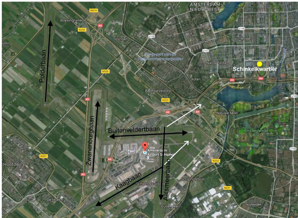
Figuur 1: Overzichtskaart van Schiphol en de richting van de geluidsoverdracht van de Aalsmeerbaan en de Kaagbaan richting Schinkelkwartier. De meetlocatie is aangegeven met de gele stip.
