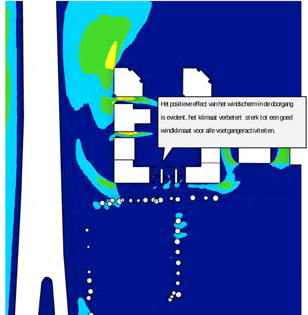
Aangevuld met windschermen in zuidelijke doorgang
