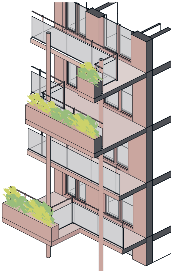
Figuur 10 Voorbeelden van alternatieven in het VO voor een rechte gevel zonder textuur of absorberende materialen.
