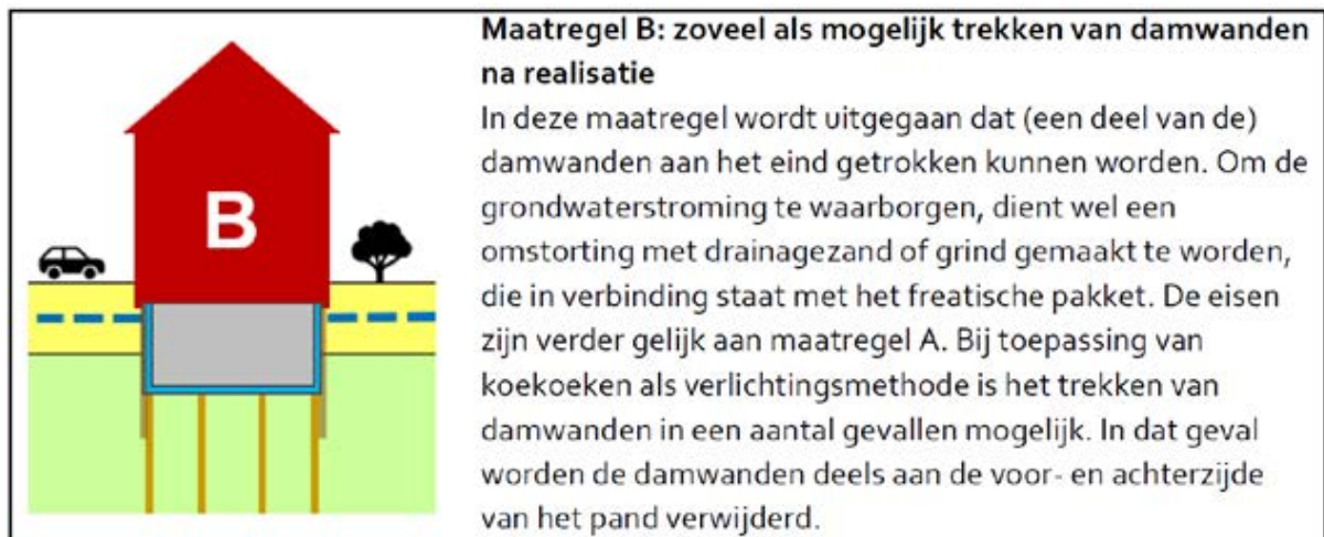
Afbeelding: schematische weergave maatregel grondverbetering
