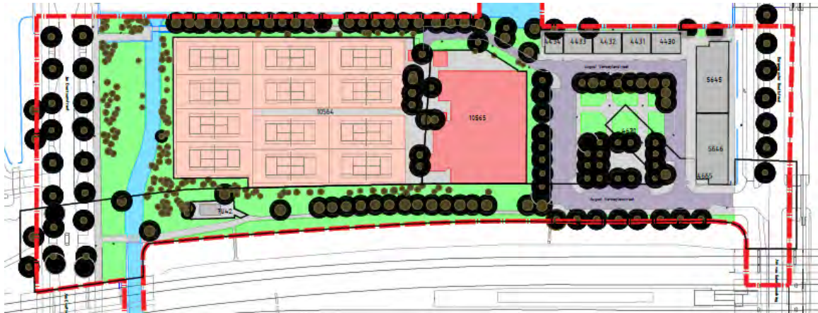
Afbeelding 2.3 Plangebied in huidige situatie. De gebouwen in rood worden gesloopt
