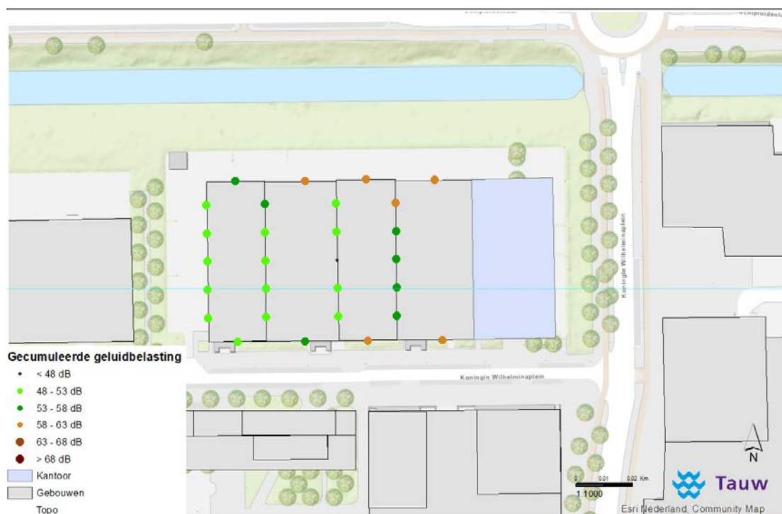
Figuur 3.4 Gecumuleerde geluidbelasting in dB (excl. aftrek art. 110g Wet geluidhinder) met bestaand pand aan de Koningin Wilhelminaplein 8-12
