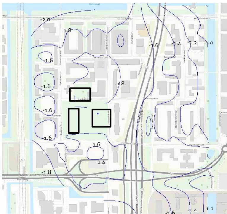
Figuur 4-2: Berekende hoge grondwaterstand [m NAP] na herinrichting inclusief klimaatverandering (contouren 0,2 m)
