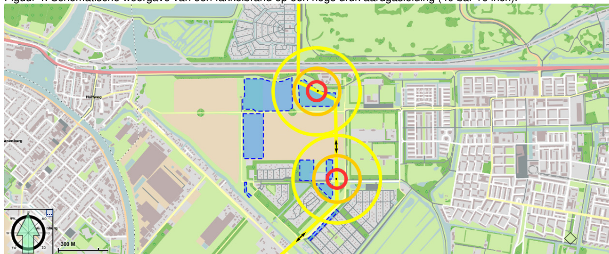
Figuur 4. Schematische weergave van een fakkelbrand op een hoge druk aardgasleiding (40 bar 16 inch).
