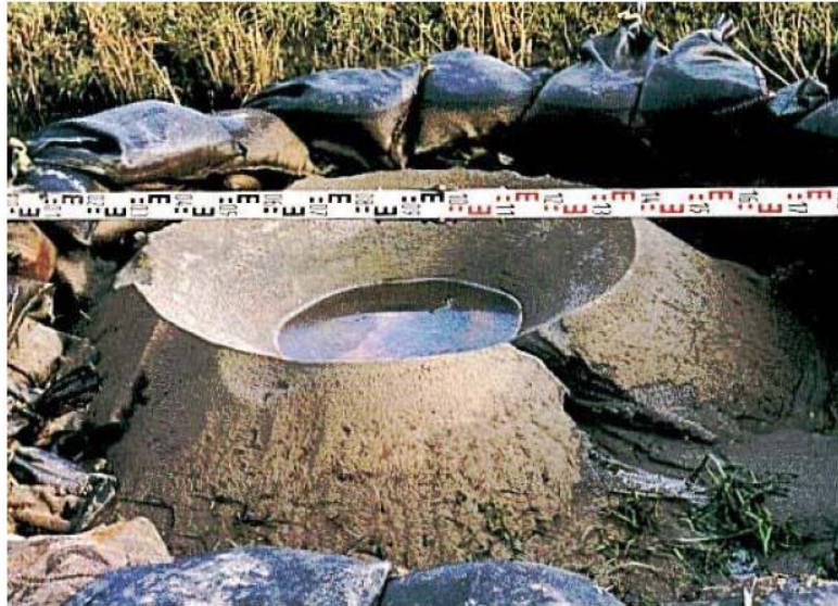
Figuur 2.4: Voorbeeld van een 'zandkrater' als gevolg van een zandmeevoerende wel
