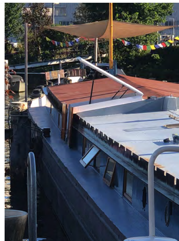
principe entree en verhuisluik met gasveren luik in houten uitvoering in lijn met luikenkap
