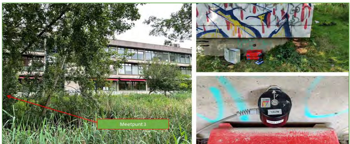
Figuur 2.5 Foto's geplaatste trillingsmeter meetpunt 3 (fundering)
