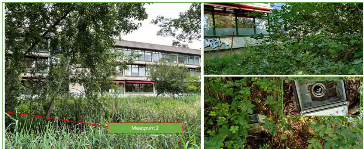
Figuur 2.4 Foto geplaatste trillingsmeter meetpunt 2 (maaiveld)
