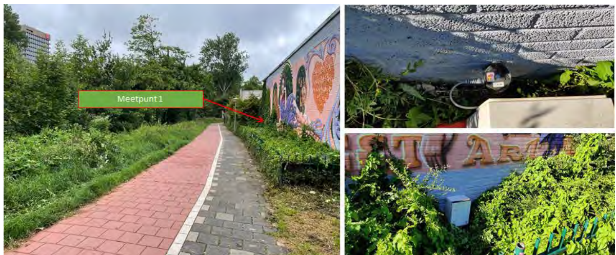
Figuur 2.3 Foto geplaatste trillingsmeter meetpunt 1 (fundering)
