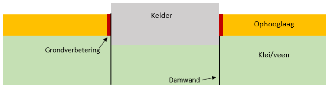
Figuur 23. Schets mitigerende maatregel: grondverbetering rondom kelder.
