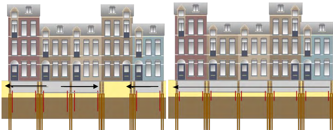
Figuur 5: Links: afsluiten ophooglaag over grote afstand, rechts: afsluiting laatste woning van huizenblok, zwarte pijl: grondwaterstroming
