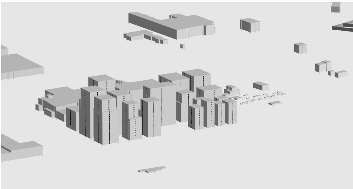
Figuur 3-8 Akoestisch model, waarneempunten als grijze bolletjes met onderlinge afstand van 3m
