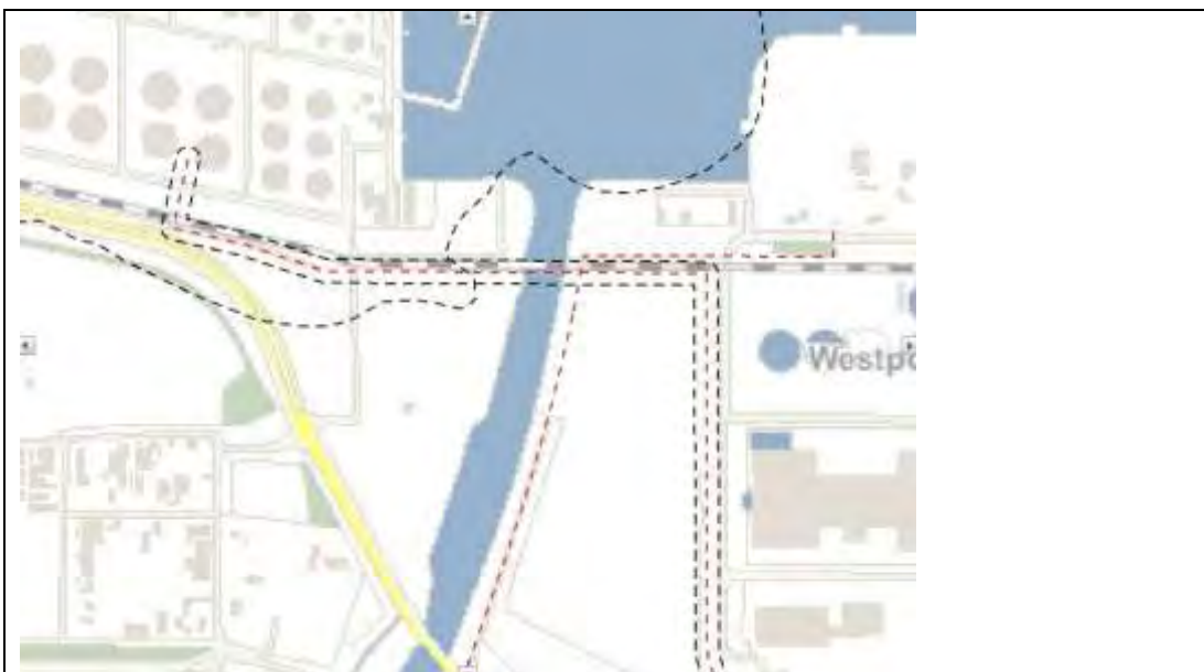
Fig 7 – Kerosineleiding (rood gestreept) en contour PR 10^{-6} van 15 m (zwart gestreept)
