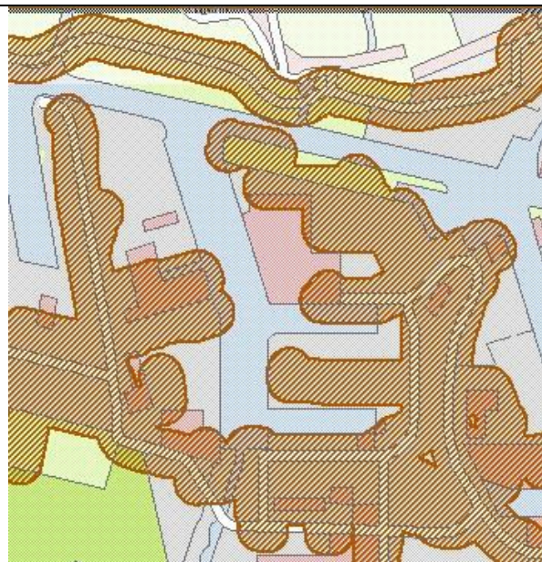
Fig 22 - Zone 200 meter t.g.v. transport over de weg
