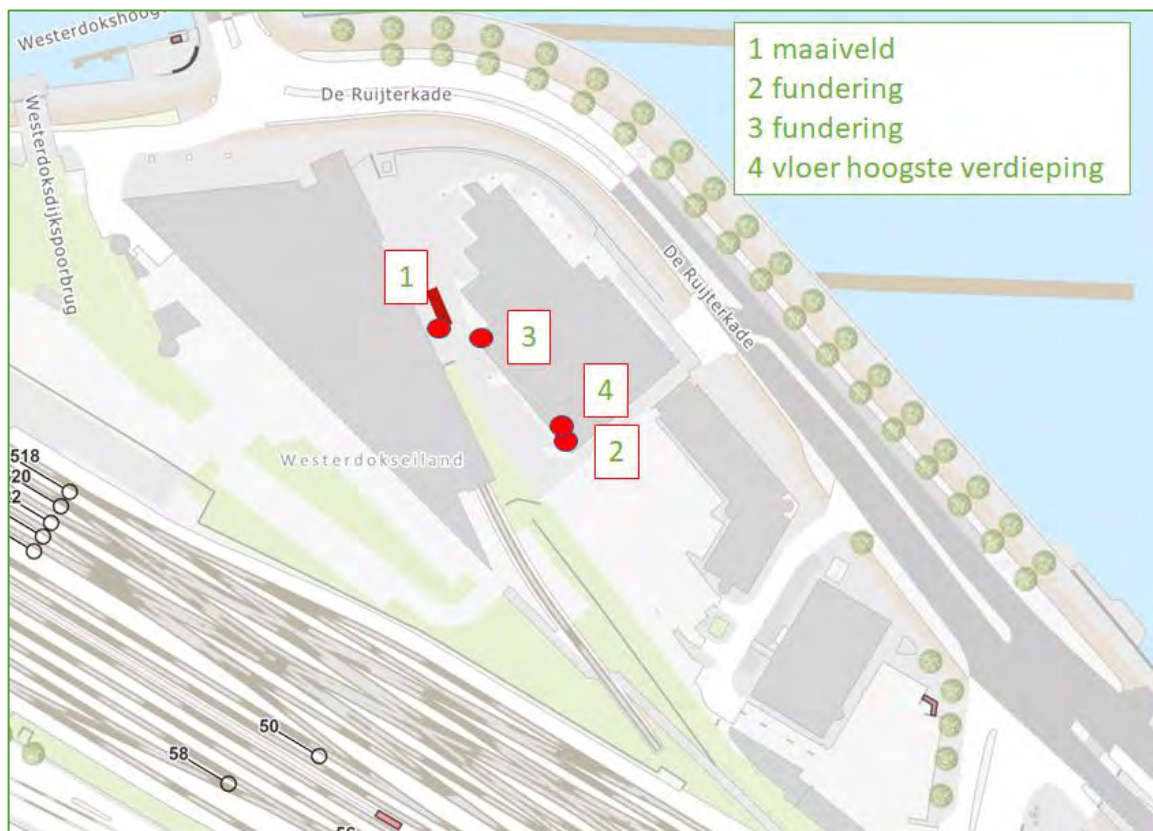
Figuur 2 Meetlocaties trillingsmetingen ten opzichte van de geprojecteerde nieuwbouw
