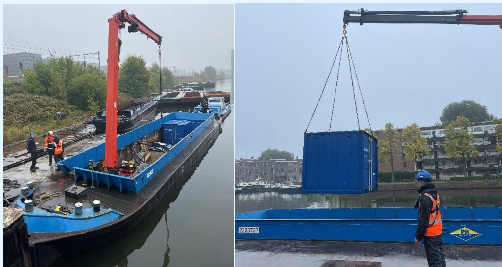
figuur 2: overslag van een metalen container tijdens de simulatie
