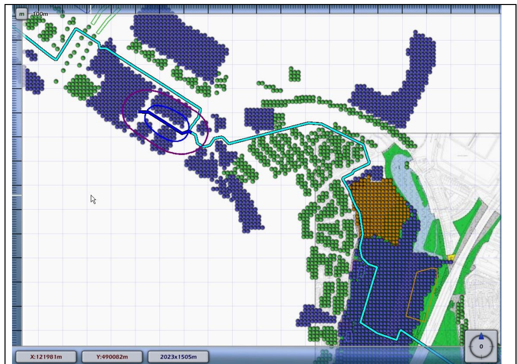
Figuur 5: Weergave van het plaatsgebonden risico voor de leiding W-572-03.
