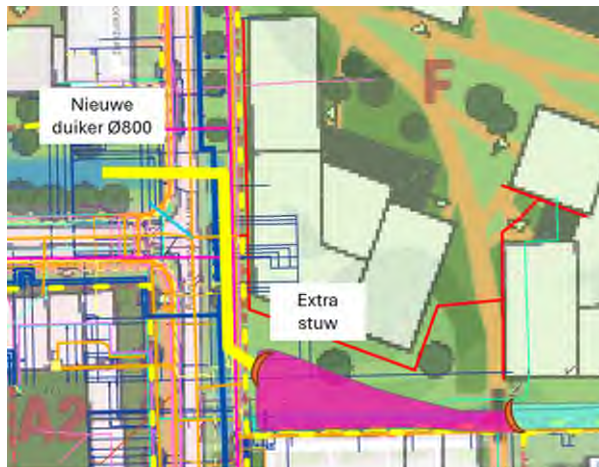
Figuur 5-7 Indicatieve loop van een mogelijke duiker om het watersystemen aan oostzijde van Clusters C en F te verbinden met de watergang bij de weg Uilenstede, in combinatie met de retentievijver.
