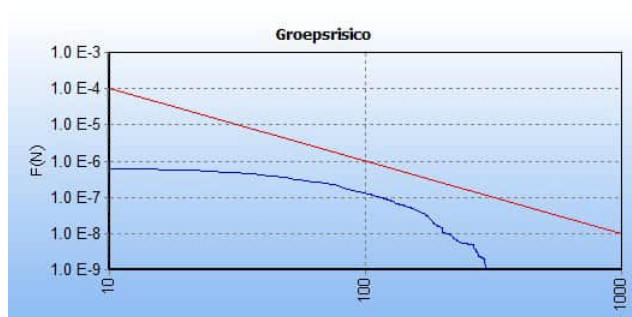
Figuur 10 FN-curve van de kilometer met de hoogste overschrijdingsfactor van gastransportleiding W-540-01 in de toekomstige situatie. De ligging van deze kilometer is hiernaast in het rood weergegeven op een topografische kaart.
