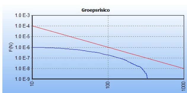
Figuur 7 FN-curve van de kilometer met de hoogste overschrijdingsfactor van gastransportleiding W-540-01 in de huidige situatie. De ligging van deze kilometer is hiernaast in het rood weergegeven op een topografische kaart.
