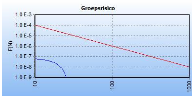
Figuur 5.1 FN curve voor 9430_leiding-W-529-02-deel-1 van N.V. Nederlandse Gasunie voor de kilometer tussen stationing 340.00 en stationing 1340.00
