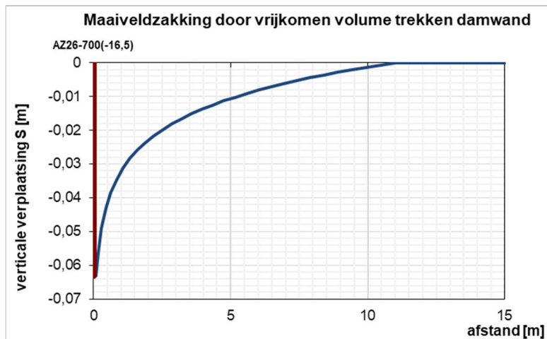
Figuur 14 Maaiveldzakking ten gevolge van statisch trekken van damwand AZ26-700 (NAP-16,5m) en mv op NAP-0,8m
