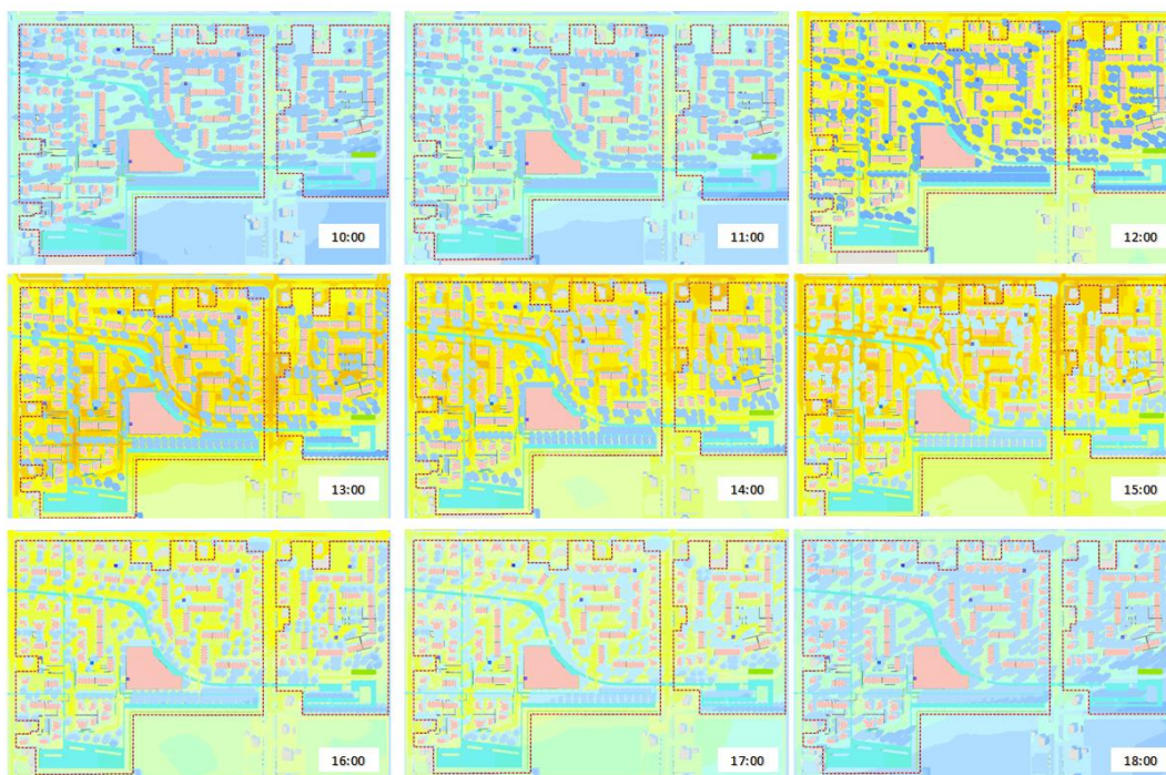
Figuur 4: Gemiddelde gevoelstemperatuur gedurende een hete dag – gemodelleerd per tijdsframe (10:00-18:00 uur). Bron: Tygron.
