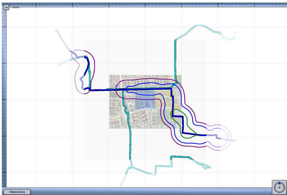
Figuur 3 - Plaatsgebonden risicocontouren leiding A-807
