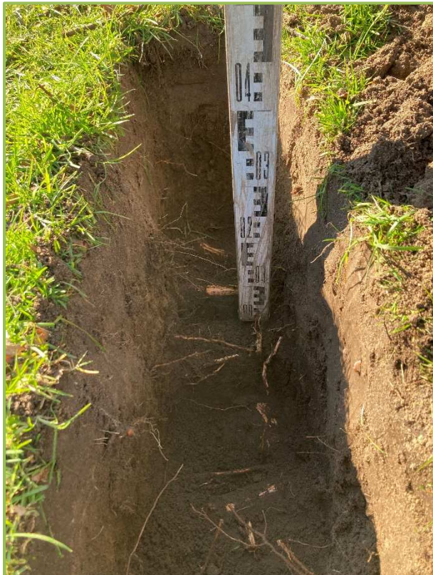
Detailfoto van de proefsleuf waar tussen 40 en 50 cm -mv meerdere dikkere wortels ( \varnothing < 4 cm) aanwezig zijn .
