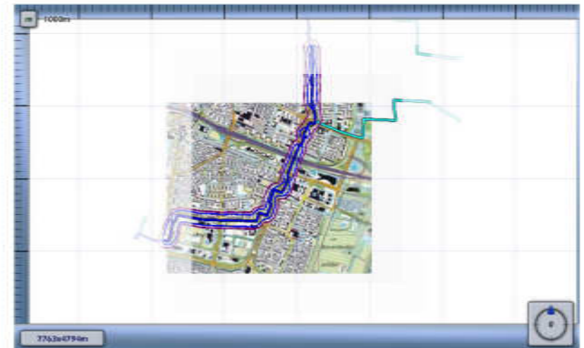
3.3 Figuur 3.3 Plaatsgebonden risico voor 1023_leiding-W-540-01-deel-2 van N.V. Nederlandse Gasunie
