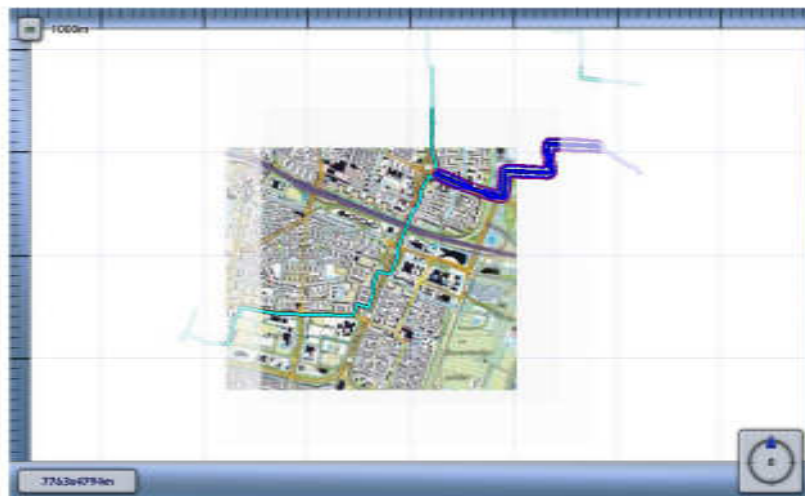
3.5 Figuur 3.5 Plaatsgebonden risico voor 1023_leiding-W-540-03-deel-1 van N.V. Nederlandse Gasunie
