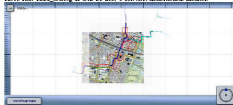
Figuur 4.2 Kilometer leiding behorende bij de maximale overschrijding van de FN-curve voor 1023_leiding-W-540-01-deel-1 van N.V. Nederlandse Gasunie
