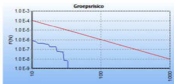
5.5 Figuur 5.5 FN curve voor 1023_leiding-W-540-03-deel-1 van N.V. Nederlandse Gasunie voor de kilometer tussen stationing 0.00 en stationing 1000.00
