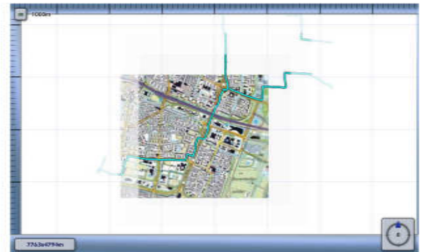
3.3 Figuur 3.3 Plaatsgebonden risico voor 1023_leiding-W-540-01-deel-2 van N.V. Nederlandse Gasunie
