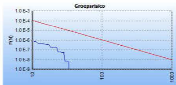
5.5 Figuur 5.5 FN curve voor 1023_leiding-W-540-03-deel-1 van N.V. Nederlandse Gasunie voor de kilometer tussen stationing 0.00 en stationing 1000.00
