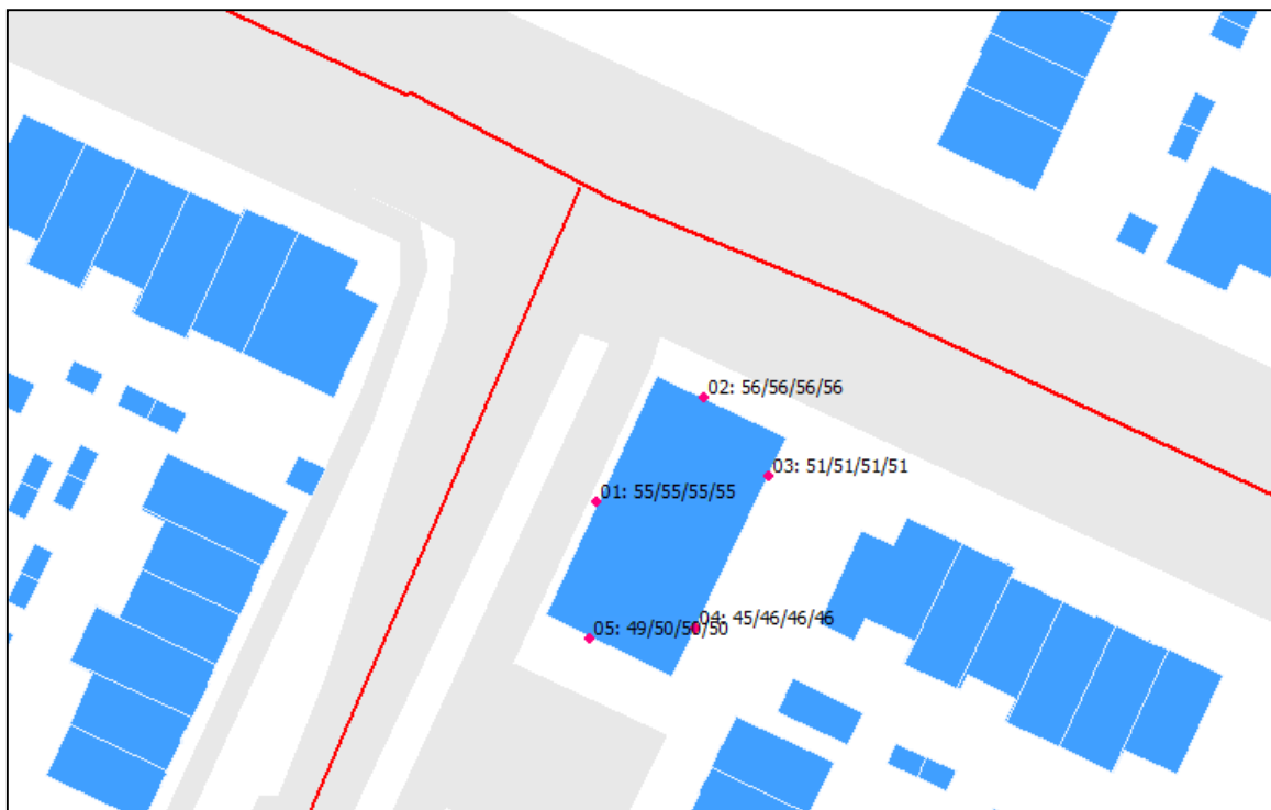
Afbeelding 4 Geluidsbelasting in dB per bouwlaag van alle wegen tezamen na aftrek van 5 dB
