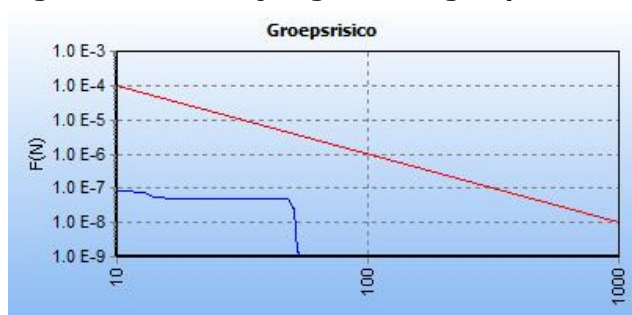
Figuur 8 FN-curve van de kilometer met de hoogste overschrijdingsfactor (0.01) van de W-529-01. De ligging van de kilometer met de hoogste overschrijdingsfactor is hiernaast in het groen weergegeven op een topografische kaart.
