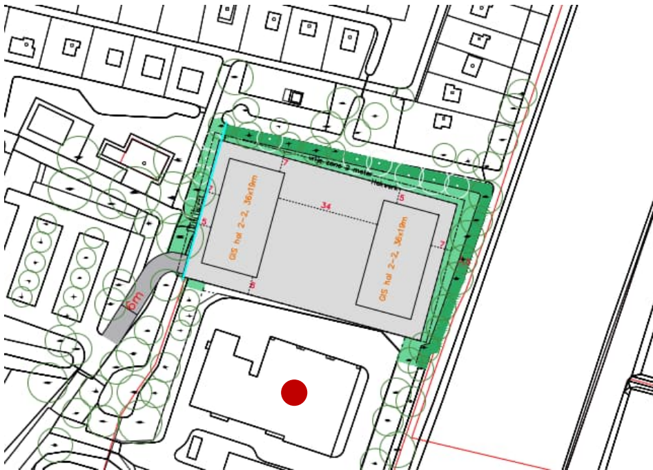
Figuur 2.1 | Uitbreidingslocatie hoogspanningsstation Amstelveen (met de rode stip is het bestaande hoogspanningsstation aangegeven)
