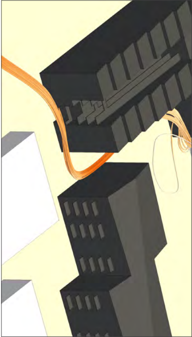
Figuur 2.6: Stroomlijnen van de wind die door het klasse C gebied stromen tussen blok 4 en 5
