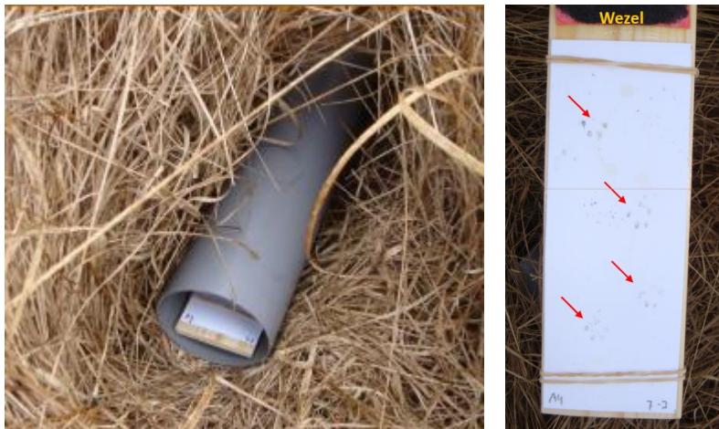
Afbeelding 3. Sporenbuis in het veld (links) en wezelsporen (rechts) op het sporenplankje.
