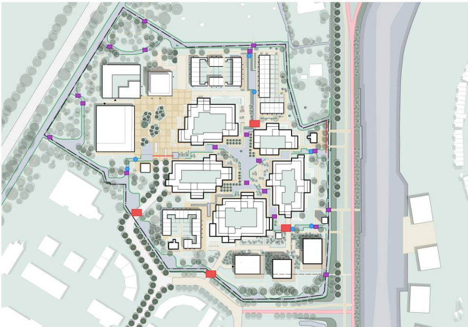
Figuur 12: Toekomstige kunstwerken in het plangebied. Rood: verkeersbrug. Paars: voetgangers- en/of fietsbrug. Rode lijn: duiker. Blauw: stuw of dergelijk object om water en vijvers te scheiden.
