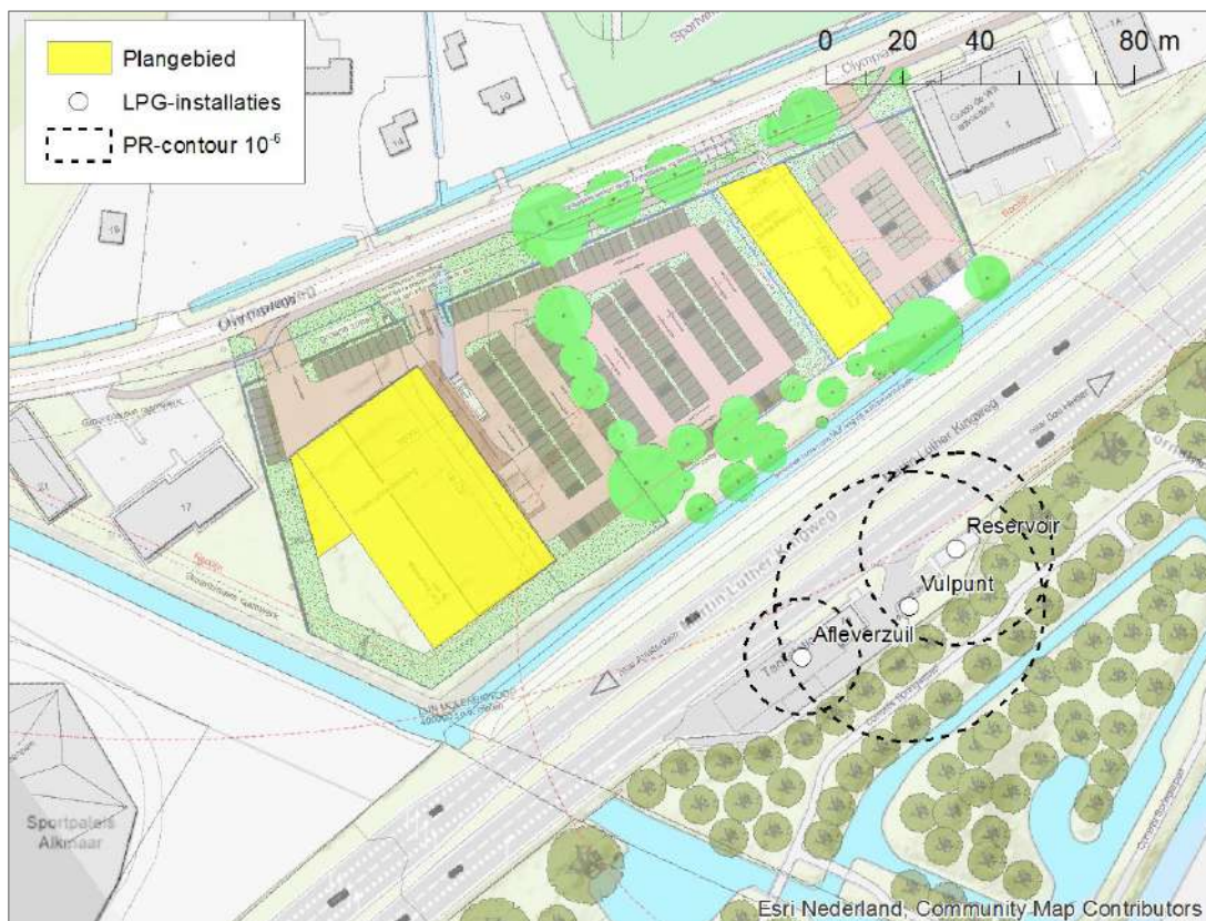
Figuur 5. Plaatsgebonden risicocontouren 10^{-6}
