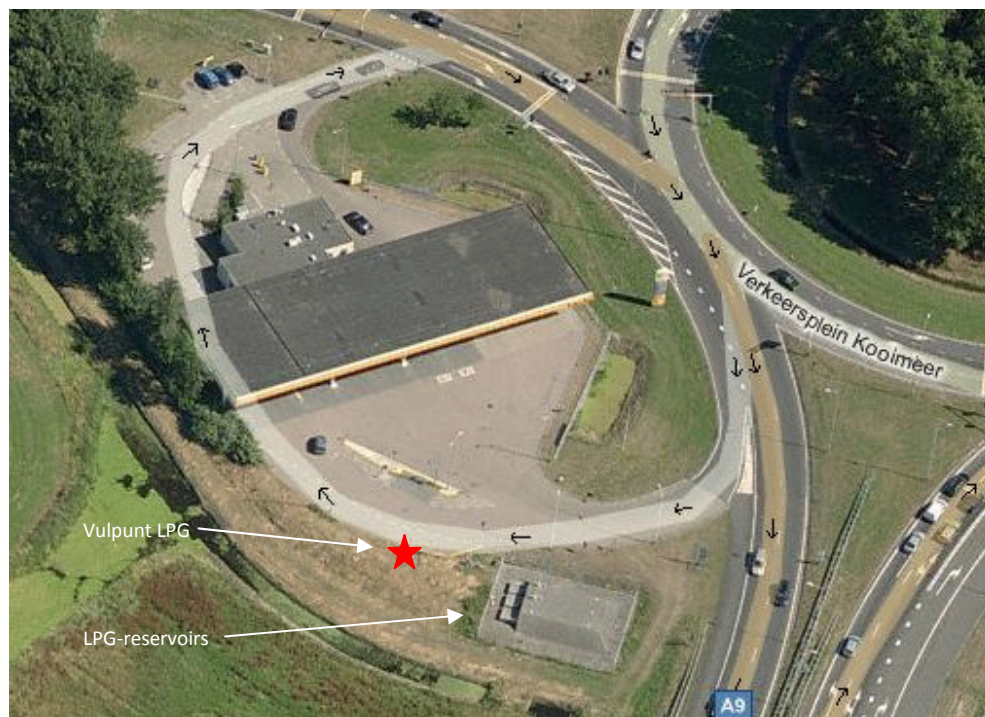
Figuur 4 LPG-tankstation met risicorelevante onderdelen
